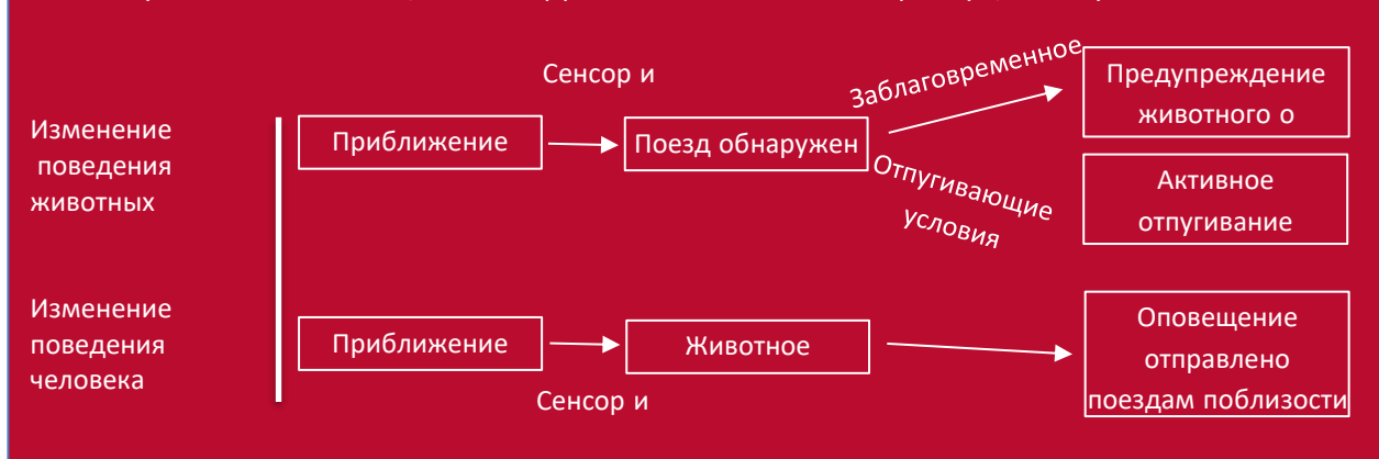
Рисунок 17: Концептуальный механизм поддерживающий меры предосторожности технического характера по уменьшению числа столкновений поездов и дикой фауны
