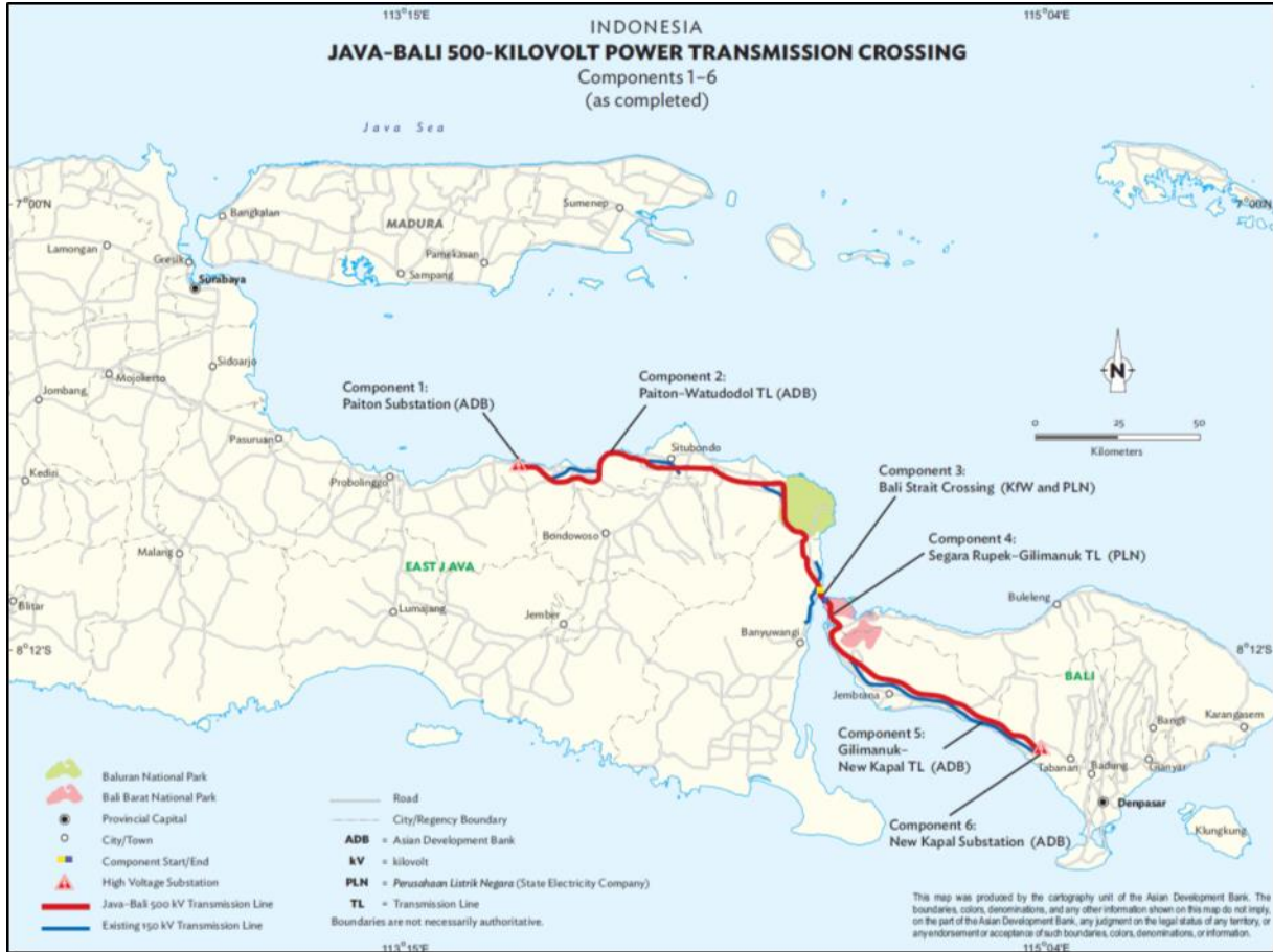
ภาพที่ 22 แสดงตำแหน่ง และคำอธิบายของส่วนประกอบ 1 ถึง 6 ของโครงการเกาะชวา - เกาะบาหลี 500 กิโลโวลต์ แหล่งที่มา: ธนาคารเพื่อการพัฒนาแห่งเอเชีย (ADB) อินโดนีเซีย: โครงการสายส่งไฟฟ้าข้ามฟากแรงดัน 500 กิโลโวลต์ เกาะชวา - เกาะบาหลี รายงานสมบูรณ์ กุมภาพันธ์ 2021
