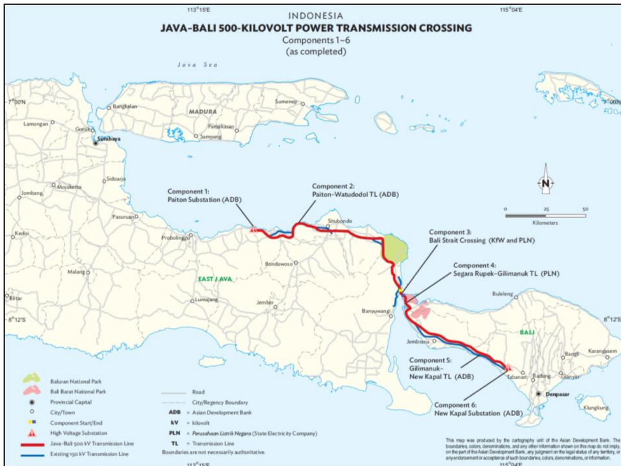
22Зураг: Жавагаас Бали хүртэлх 500киловольт шугамын төслийн 1-ээс 6 хүртэлх бүрэлдэхүүн хэсгүүдийн байрлал, танилцуулга. Эх сурвалж: Азийн Хөгжлийн Банк. Индонез: Жавагаас Бали хүртэлх 500 киловольтын цахилгаан дамжуулах шугамын зөрлөгийн төсөл. Гүйцэтгэлийн Тайлан. 2021 оны хоёрдугаар сар.
