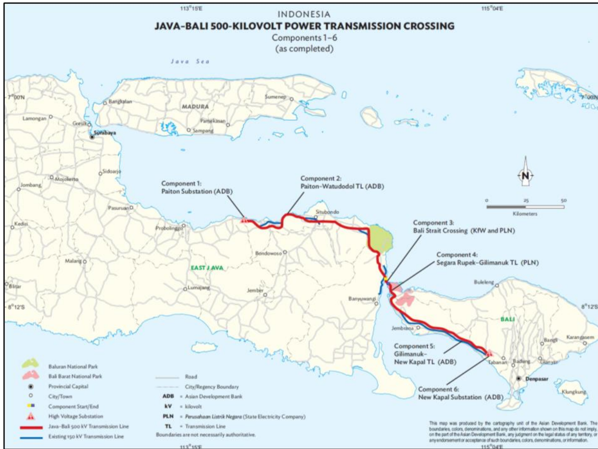
চিত্র 22: জাভা-বালি 500-kV প্রকল্পের কম্পোনেন্ট। থেকে 6-এর অবস্থান ও বর্ণনা সূত্র: এশীয় উন্নয়ন ব্যাংক ইন্দোনেশিয়া: জাভা-বালি 500-kV পাওয়ার ট্রান্সমিশন ক্রসিং প্রজেক্ট। সমাপ্তির প্রতিবেদন (কমপ্লিশন রিপোর্ট)। ফেব্রুয়ারি 2021।
